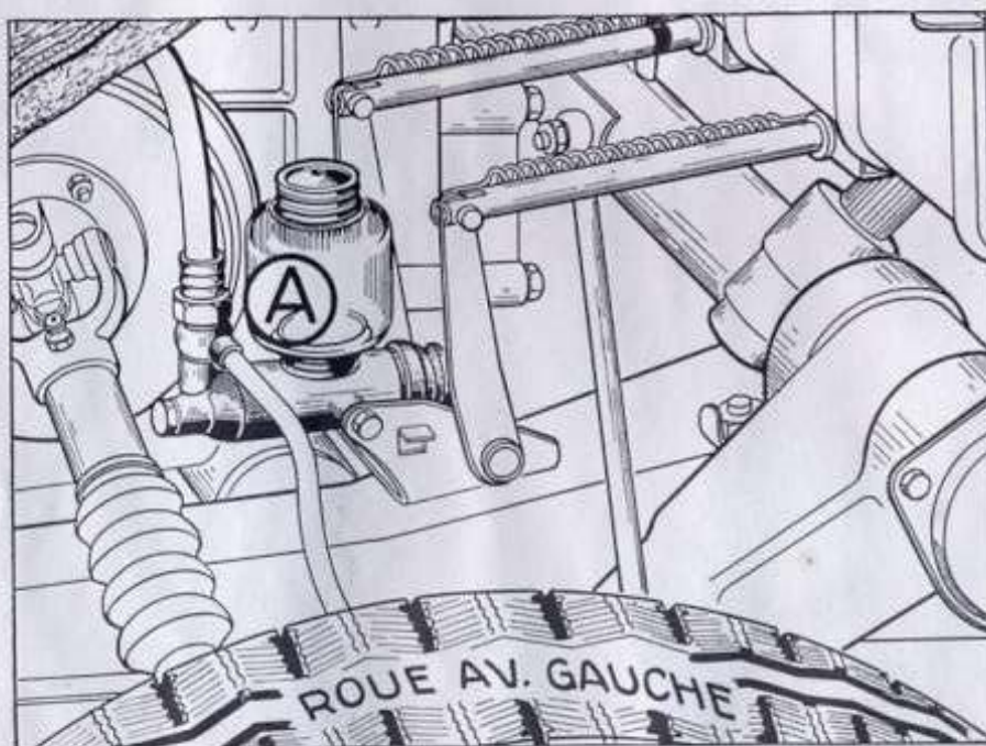
Fig. 2. — RÉSERVOIR DU LIQUIDE POUR FREINS (A)
