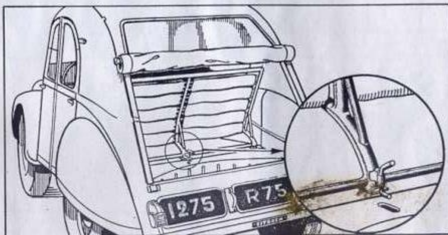
Fig. 22. — DÉPOSE DE LA BANQUETTE AR
