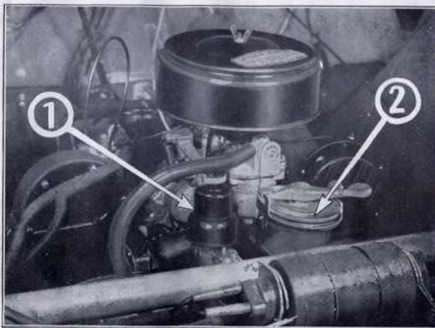
Fig. 16. — RENIFLARD D'HUILE (1) (clapet à l'intérieur) ORIFICE DE REMPLISSAGE (2)
