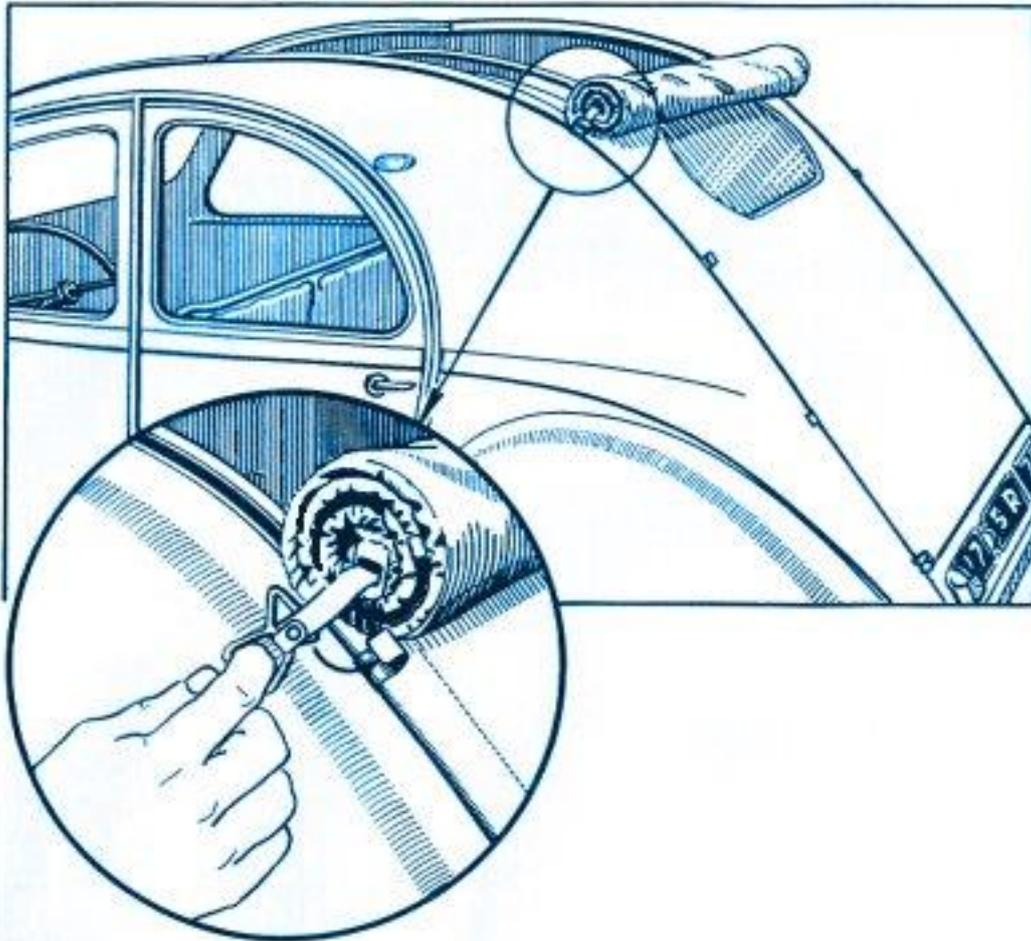
Lors de la fermeture de la capote, s'assurer que les crochets sont bien engagés dans les pontets de maintien [repère 3]
